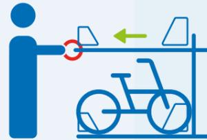
**2** Schiene bis zum Anschlag nach unten drücken.
