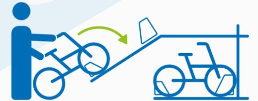
**4** Fahrrad komplett in die Führungsschiene schieben.
