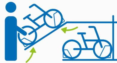
**6** Schiene am roten Griff nach oben schieben. Gasdruckfedern helfen Ihnen dabei, um den notwendigen Kraftaufwand zu minimieren.
